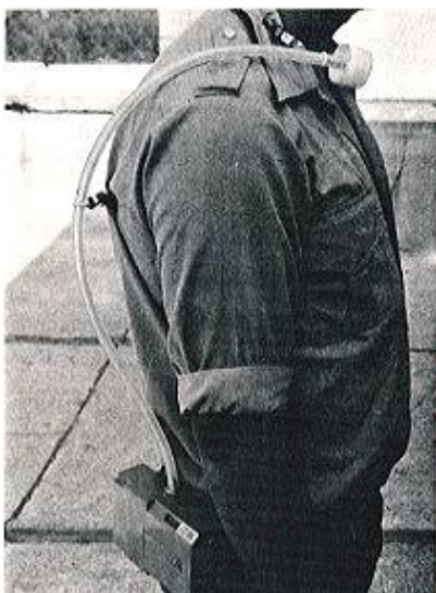
Fig. 5: Toma de muestra con cassette
