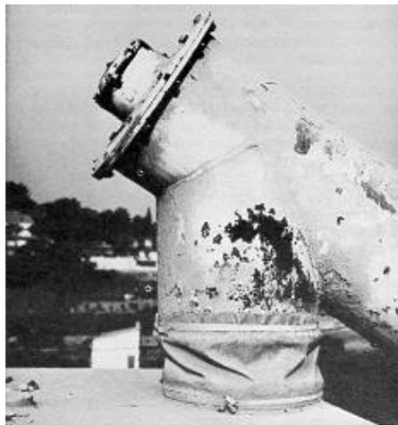
**Figura 5. Enlace flexible entre tornillo transportador y báscula**
