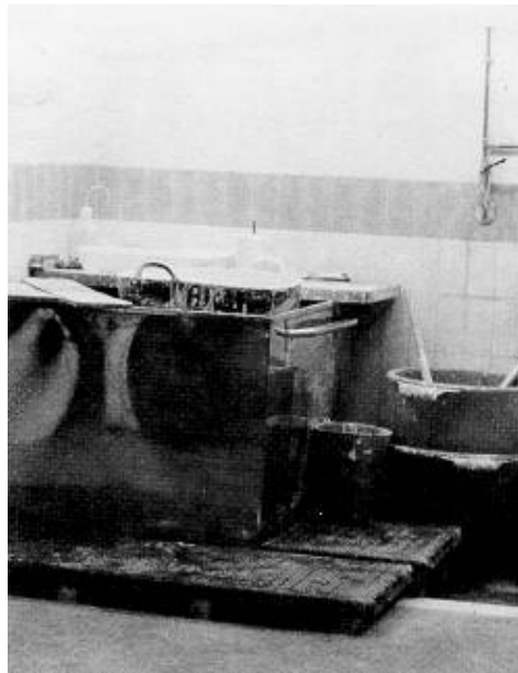
Fig. 2: Área para barnizado. La operación se efectúa sobre un depósito de acero inoxidable, que se encuentra sobre un suelo a menor nivel con lecho de agua. Paredes de azulejo con "cortina de agua". La zona sobre la que se dispone el trabajador, de goma negra para advertir posibles proyecciones
