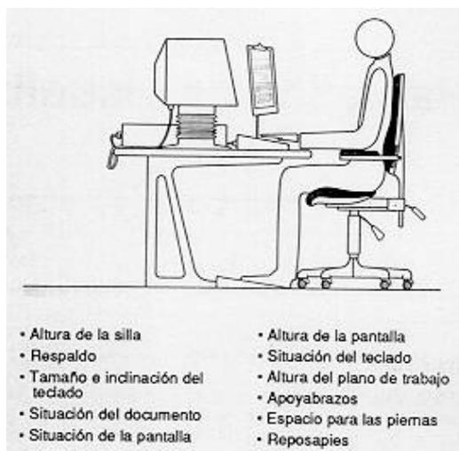
**Fig. 1: Factores del diseño geométrico. Incidentes en las molestias músculo-esqueléticas**
