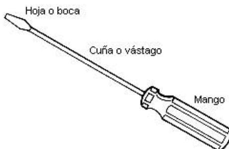
**Fig. 11: Partes de un destornillador**
