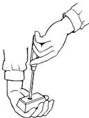
**Fig. 14: Sujeción incorrecta de una pieza a atornillar**
