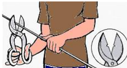
Fig. 15 Utilización incorrecta de tijeras con hojas melladas
