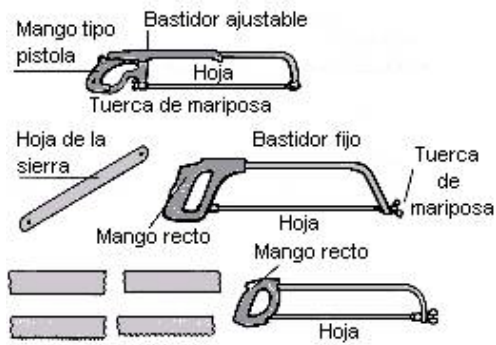
Fig. 12: Partes y tipos de sierras de arco
