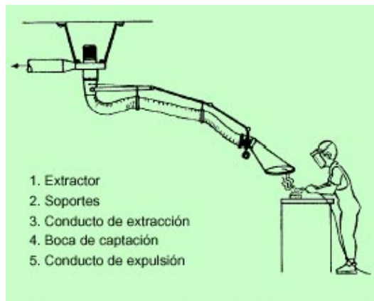
Fig. 3: Sistema móvil de extracción localizada
