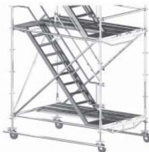
Figura 16 Ruedas unidas mediante tubo para desplazamientos rectos
