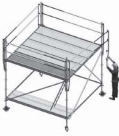
Figura 5 Montaje de barandillas y rodapiés desde el nivel superior
