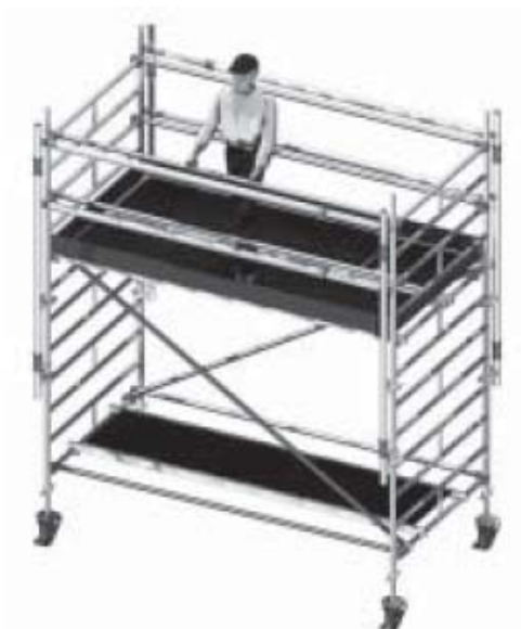
Figura 9 Finalización del piso de trabajo con barandillas y rodapiés perimetrales
