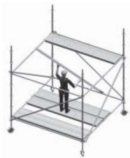
Figura 4 Montaje de la protección superior (pies y largueros de seguridad)
