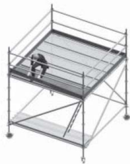
Figura 5 Montaje de barandillas y rodapiés desde el nivel superior
