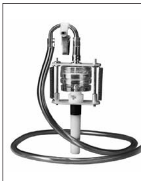
Figura 4. Ciclón de nylon 10 mm
