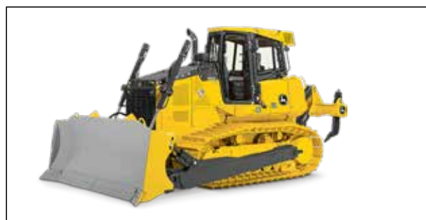
Figura 1. Niveladora de cadenas equipada con hoja o pala de arrastre y escarificador trasero
