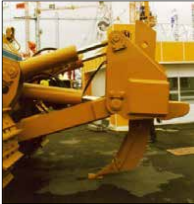
Figura 4. Ejemplo de accesorio trasero. Detalle de un escarificador.
