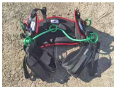
Figura 18. Arnés específico de trepa.
