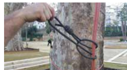
Figura 19b. Ejemplo de confección de un nudo autoblocante..
