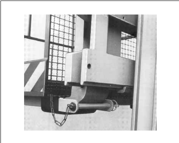
Figura 3. Dispositivo de bloqueo de los canales de la plataforma
