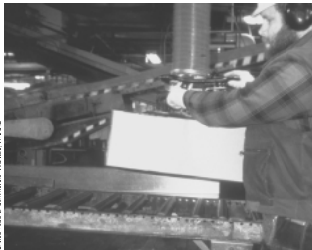
Figura 67.6 • La utilización de elevadores por vacío para levantar cajas permite a los trabajadores moverlas sin tener que cargarlas a mano.
