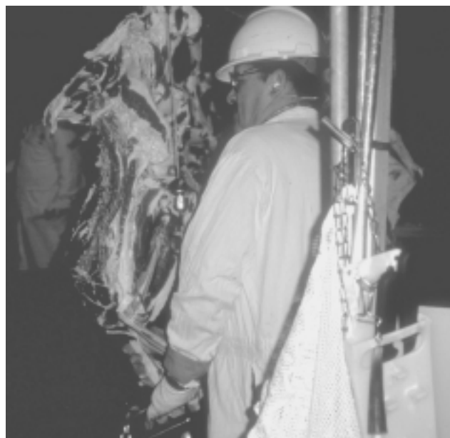
Figura 67.5 • Extraer los huesos de las aletas mediante la fuerza de una cadena anexa, evitando la extracción manual, reduce los riesgos musculoesqueléticos.
