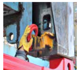
Figura 12. Ejemplo de unión cesta-spreader
